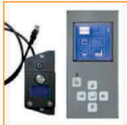
Thermowatt arıza/çalışma değerleri inceleme kiti ve ekranı
